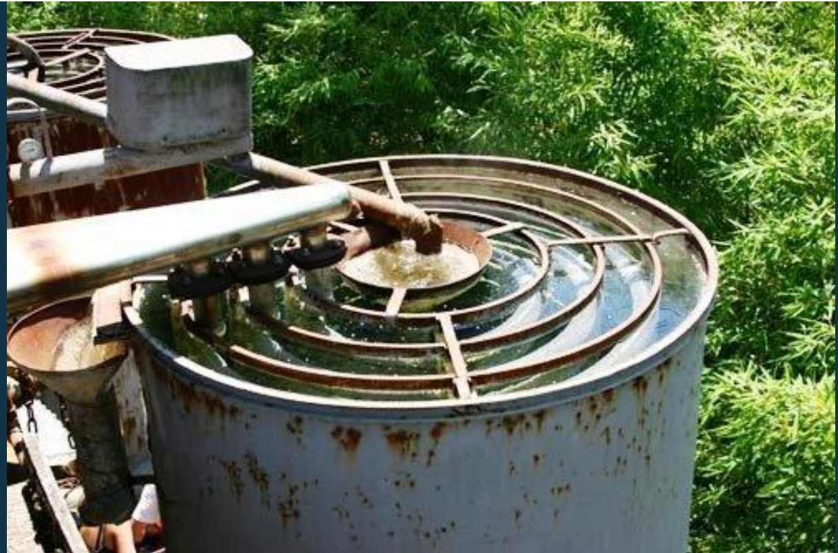
un condenseur à 3 serpentins de refroidissement classique, d'utilisation courante dans les distilleries
